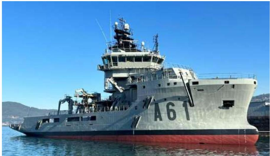
*Dispone de una eslora de 67 metros, una manga de 16 metros, un calado de 5,4 metros, con una capacidad de remolque de 65 toneladas. Su planta propulsora se compone de dos motores Man con una potencia naval de 1930 kw cada uno.*
