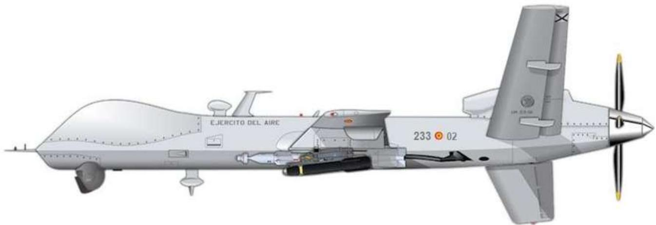
*Del Predator se adquirieron cuatro unidades de la versión Block 5. Su configuración está determinada para operar con misiles aire-superficie mediante el sistema Modified Weaponization Kit (UHK16205-1).*
