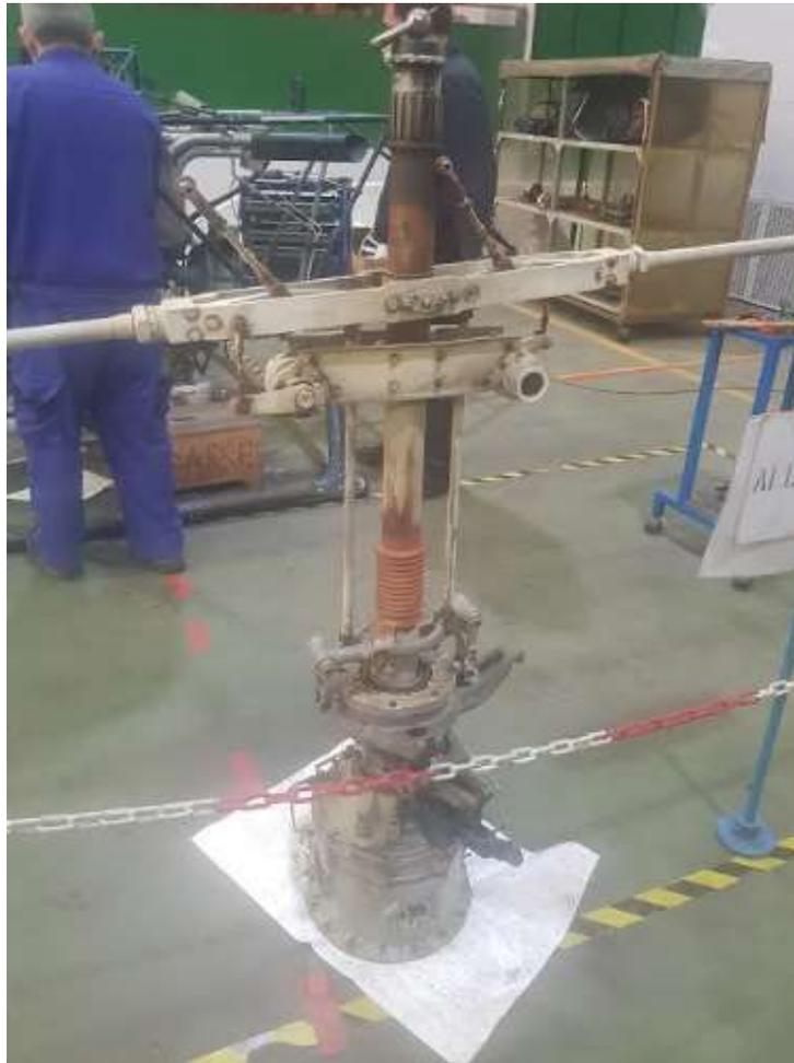
*El rotor desmontado para su reparación / MAESE*
