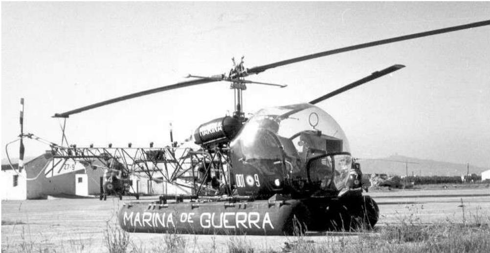
***El Bell G-47 con el numeral 001-9 con flotadores en sustitución de los patines para poder amerizar / JORDI RULL – AVIAIONCORNER.NET***
