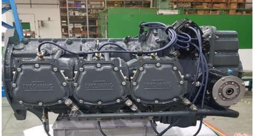
*Detalle del motor Lycoming 6 cilindros / MAESE*
