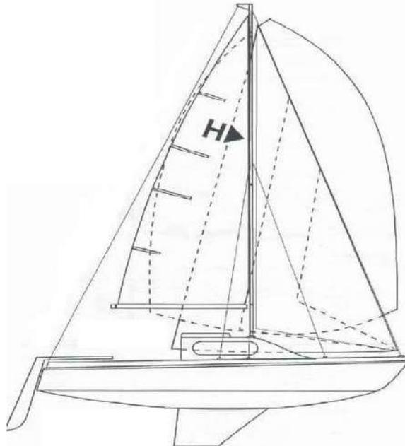
Estaba adscrita al pantano de San Juan en Madrid y fue botada en 1985 y dada de alta en la LOBA el 10/04/2013. Disponía de un motor auxiliar fueraborda Evinrude, y su desplazamiento a plena carga era en toneladas de 0,70 con una eslora de 5,80 m., una manga de 1,87 m. y un calado máximo de 0,91 m. El desarme de la embarcación se llevará a cabo en el Arsenal de Cartagena.
